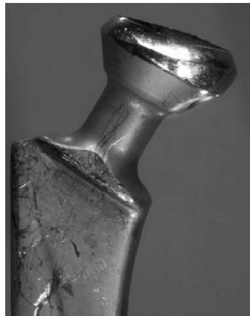
Abbildung 10 Durch Drittkörperverschleiß massiv beschädigter Metallkopf.
